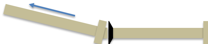
Figuur 5: Schematische weergave van het uit elkaar schuiven van de mofverbinding
