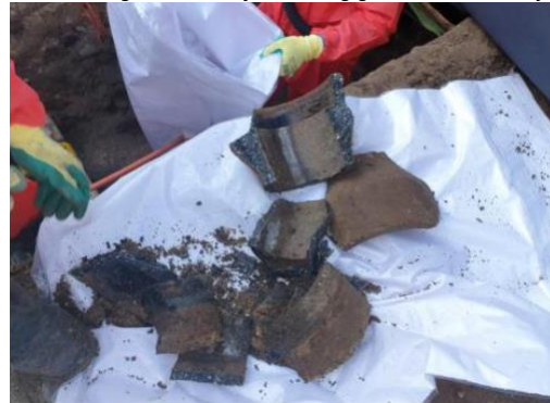
Foto 31: Uitgesneden mofverbinding gebroken met vuistje
