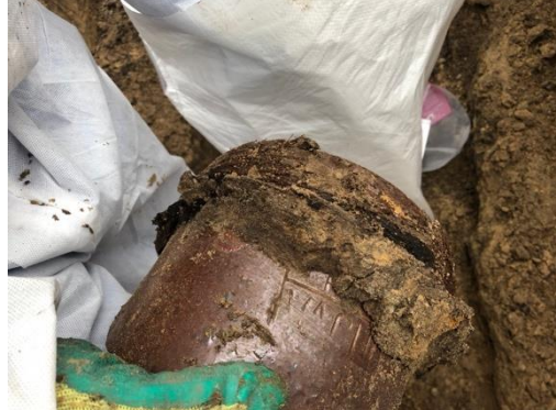
Foto 4: Ring van voegenkit blijft achter na uit elkaar schuiven
