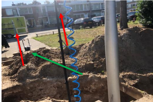
Foto 13: stationaire metingen beneden en bovenwinds (onderzoek 4)
