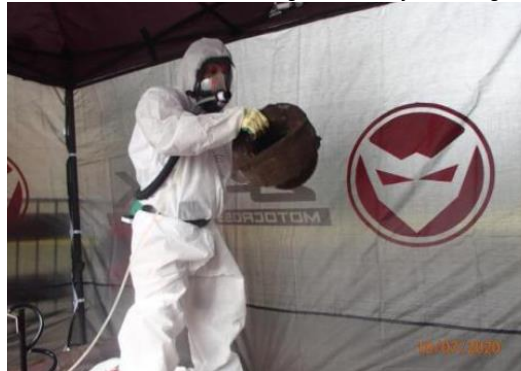
Foto 30: Laten vallen van een uitgesneden mofverbinding
