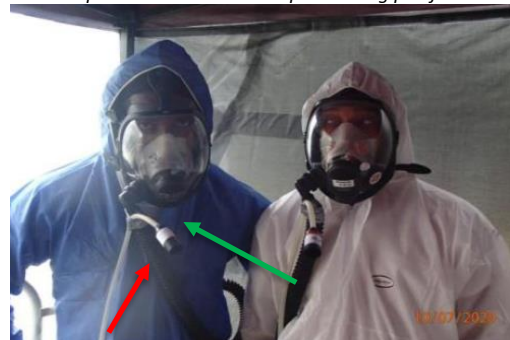
Foto 12: positie monsternamekop aan slang pro-flow-masker
